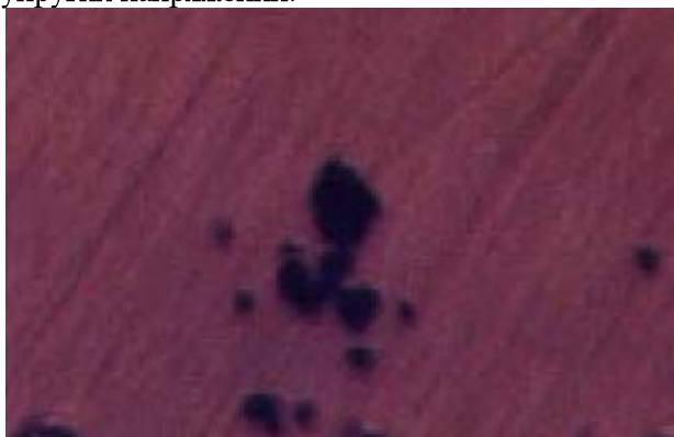
Рис.6. Разбег дислокаций от диагонали отпечатка после температурного отжига.
